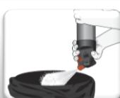
**LIMPIE** la pajilla, la boquilla, las herramientas y el área con una toalla y agua tibia. Invierta el envase de lata apuntando la parte superior hacia abajo. Rocíe una ráfaga rápida sobre una superficie desechable hasta que la textura se limpie de la punta. Quite de la boquilla cualquier formación de textura. **ALMACENE** a temperatura ambiente, evite el frío o el calor extremos.
