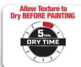
**PARA PINTAR:** Permita que la textura seque por 5 minutos antes de pintarla. El tiempo de secado puede ser mayor en condiciones frías/húmedas o con aplicaciones más gruesas. Siga las instrucciones del fabricante de la pintura para obtener los mejores resultados. Para aplicaciones exteriores/expuestas a la humedad, primero aplique una imprimación impermeable antes de la exposición a la humedad.
