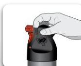
**DESBLOQUEE** la lengüeta doblándola hacia atrás. LA LENGÜETA DE SEGURIDAD ESTÁ DISEÑADA PARA VOLVER A BLOQUEARSE, NO LA ROMPA.
