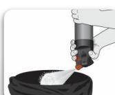
**LIMPIEZA:** La textura húmeda se puede limpiar con alcoholes minerales. La textura seca se deberá cortar, raspar o lijar. Coloque la boquilla en posición vertical e invierta el envase apuntando hacia abajo. Rocíe sobre una superficie desechable hasta que deje de salir textura. Asegúrese de eliminar cualquier acumulación de textura en la punta/boquilla para evitar que el material se seque en la punta/boquilla. **ALMACENAMIENTO:** Almacene en un sitio fresco y seco.
